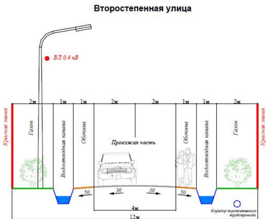
Рисунок 8-1. Схема поперечного профиля улиц «Усадьба на Волге»
